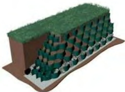
Système de soutènement des talus par géocellule multicouches. © GEOWEB
