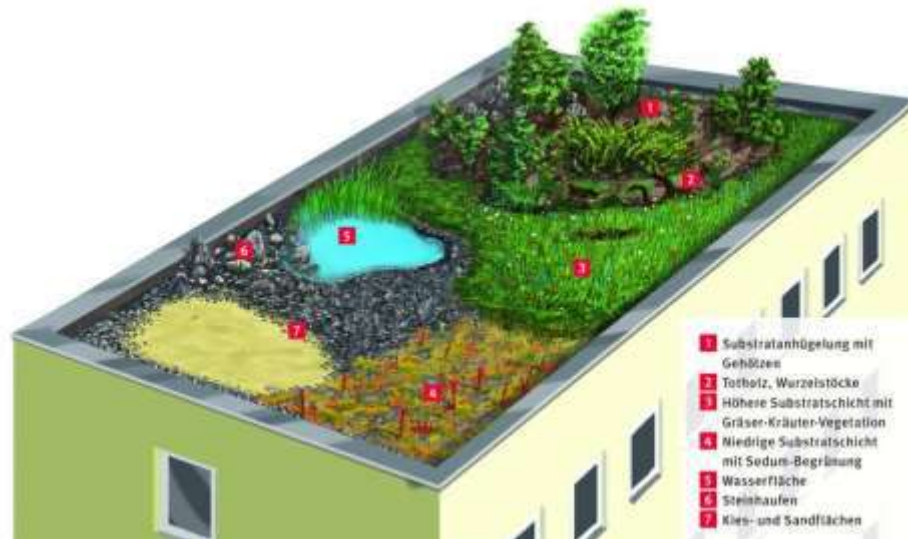
Approche de conception d'un toit vert semi-intensif pour la biodiversit © Optigrn
