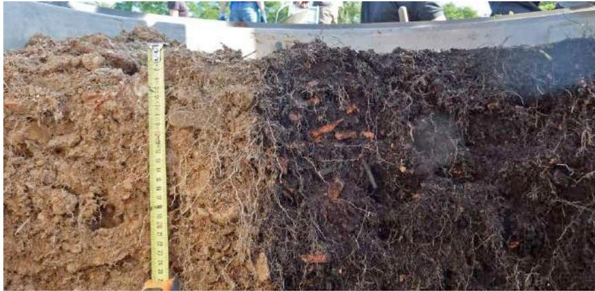
Matériaux de structure : (sur la gauche : sous-sol d'excavation + béton, sur la droite : compost de déchets verts + briques)
